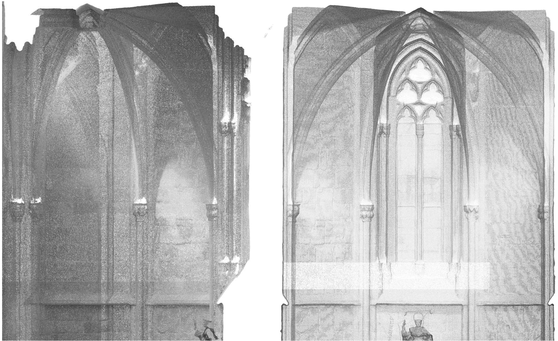
Fig. 101. Proyecciones verticales deducidas a partir de la nube de puntos 3d obtenida y facilitada por Esther Capilla para el desarrollo del proyecto I+D+i "Bóvedas de crucería valencianas de los siglos XIII a XVI. Análisis espacial, geométrico, constructivo y modelización matemática". (Expediente GV/2020/001)
