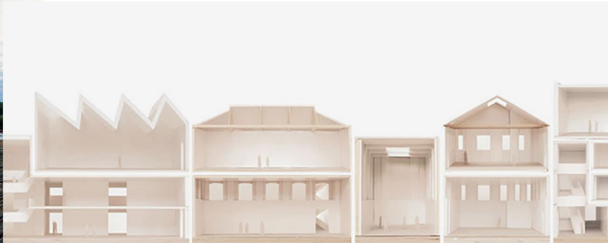
Figura III.82. Interior, las plantas baja y superior de los cinco edificios son continuas, lo que les permite utilizarse de forma flexible en muchas combinaciones
