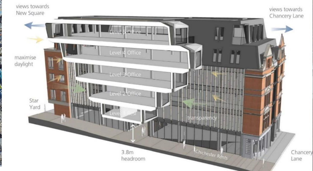
Figura III.54. Diagrama donde se aprecia su interior y cada nivel de planta escalonada está colocada en un ángulo oblicuo alterno al de arriba y al de abajo, esta ligera inclinación ayuda a maximizar la luz del día incidente
