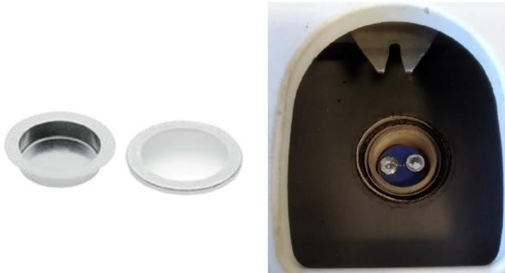
Figura 67. Crisoles de aluminio crisol vacío (Izquierda). Cisol preparado para iniciar el ensayo (Derecha).
