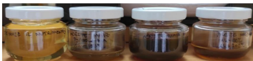
Figura 40. Diferentes estados del aceite de maíz maleinizado empleado.
