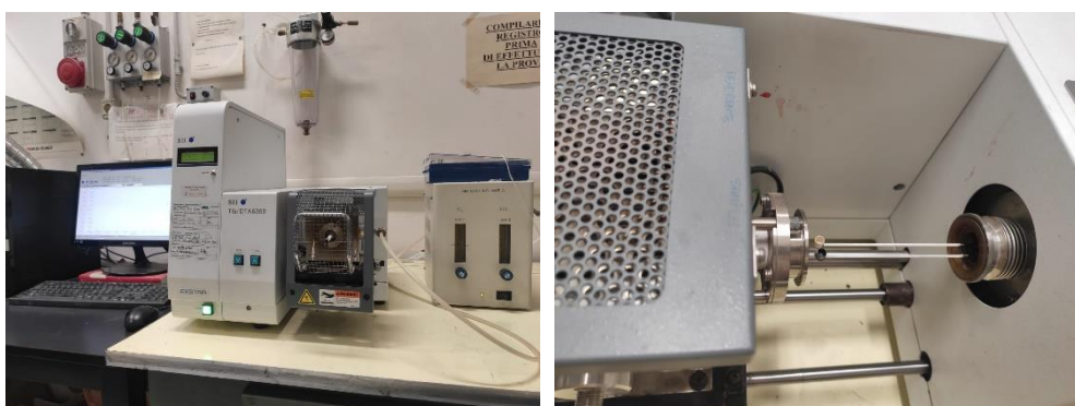
Figura 69. Máquina de análisis termogravimétrico (Izquierda) y porta muestras (Derecha).
