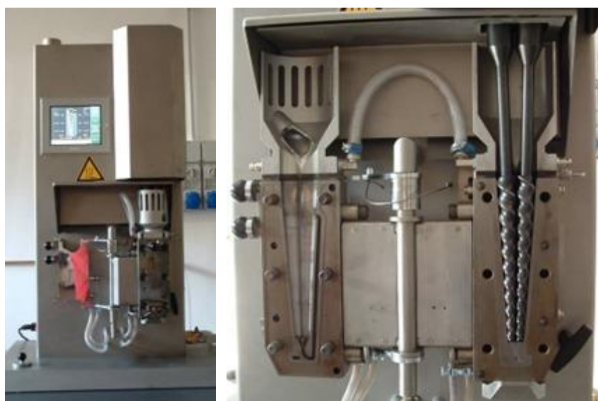
Figura 44. Extrusora (Izquierda) para procesamiento y husillos (Derecha).
