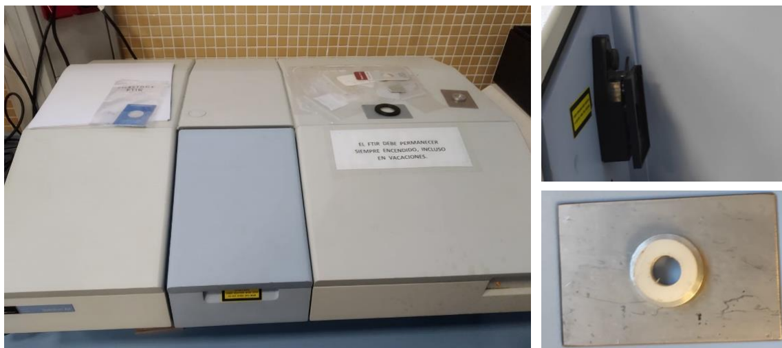
Figura 64. Espectrofotómetro infrarrojo (Izquierda) y acople para muestras traslucidas (Derecha).
