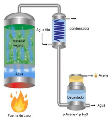
Figura 11. Esquema del proceso de destilación con agua y vapor [11].
