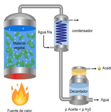
Figura 9. Esquema del proceso de destilación con agua [10].
