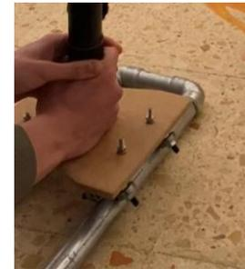
Figura 64. Tubo de PVC con un soporte de madera como dolly casero
