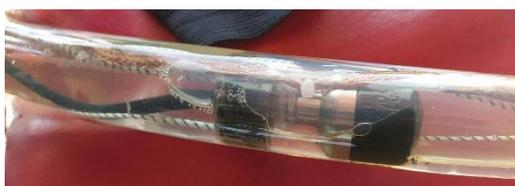
Figura 10. Hidrófono utilizado en la campaña de detección de cetáceos en el AMP del escarpe de Mazarrón.
