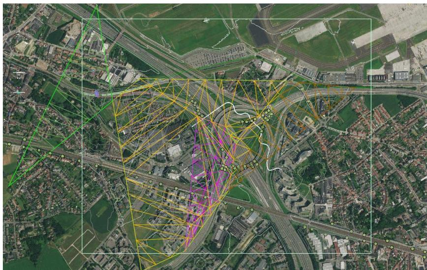
*Imagen 97. Modelo del terreno y elementos de la carretera junto los nuevos sondeos. Programa Civil 3D con la foto georreferenciada de la ubicación.*
