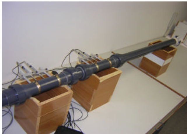
Figura 35. Montaje experimental del método de las dos fuentes. Micrófonos, muestra y salida anecoica.
