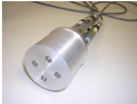
Figura 37. Pieza del montaje de calibración de los micrófonos para que queden en un mismo plano.
