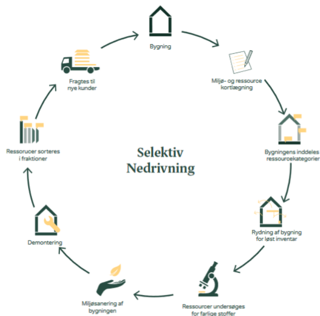
Figure 3.4: Selective demolition diagram. Based on Miljøstyrelsen, Cirkulært Kvalitetsbyggeri [33]
