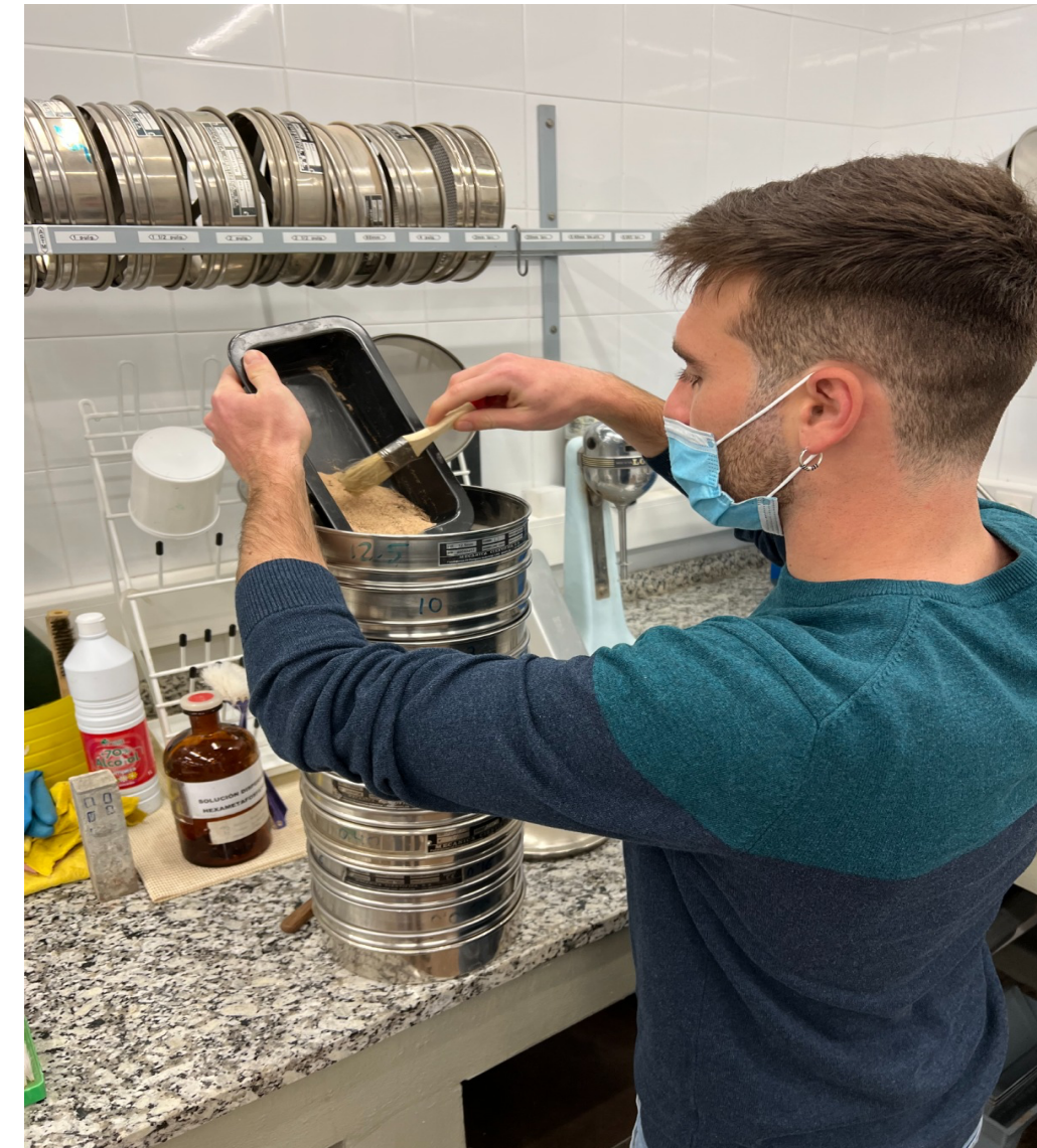
Ilustración 46. Realización del ensayo de granulometría. Fuente: Elaboración propia.
