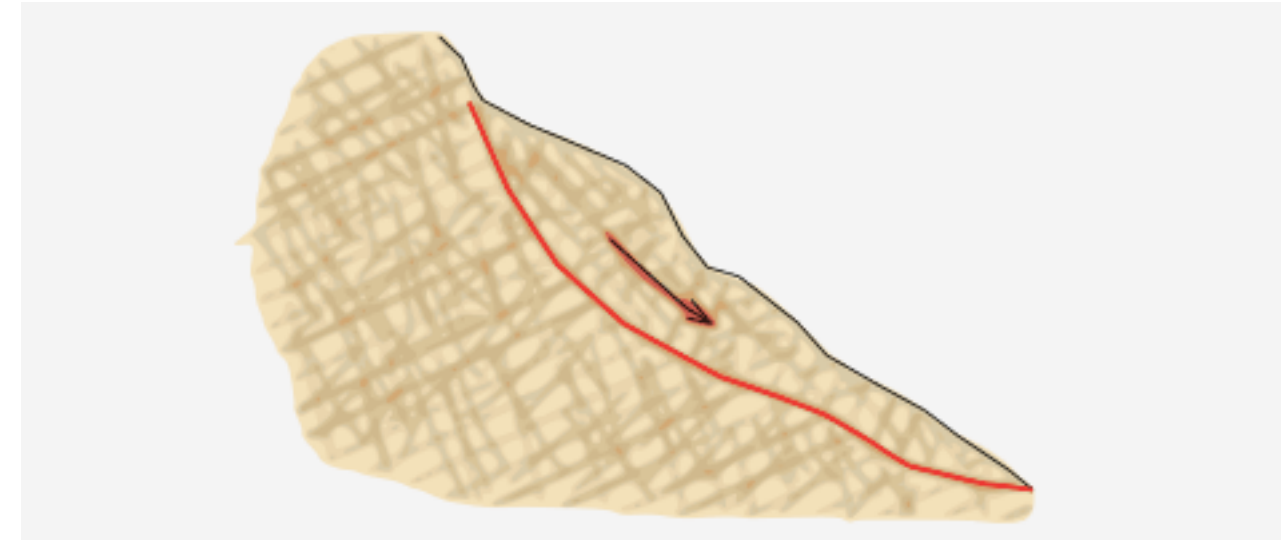
Ilustración 52. Esquema de rotura global. Fuente: Google imágenes.
