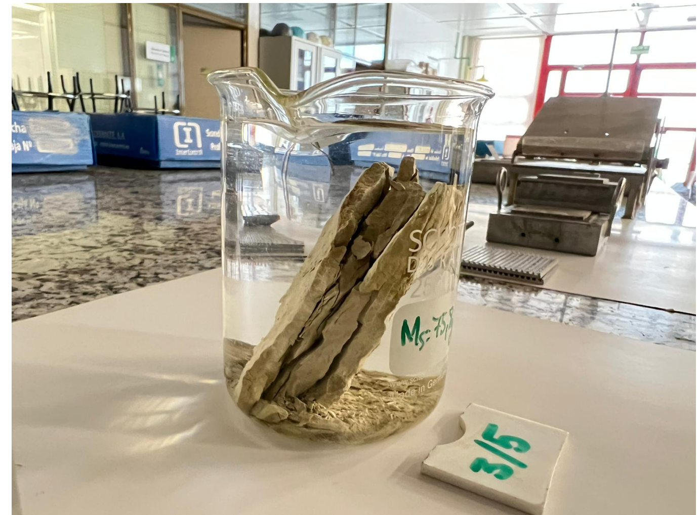
Ilustración 44. Fragmento de roca marga-caliza rompiendo por los planos de exfoliación. Fuente: Elaboración propia.
