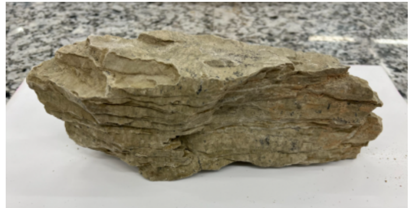
Ilustración 42. Marga en transición con los planos de exfoliación. Fuente: Elaboración propia.
