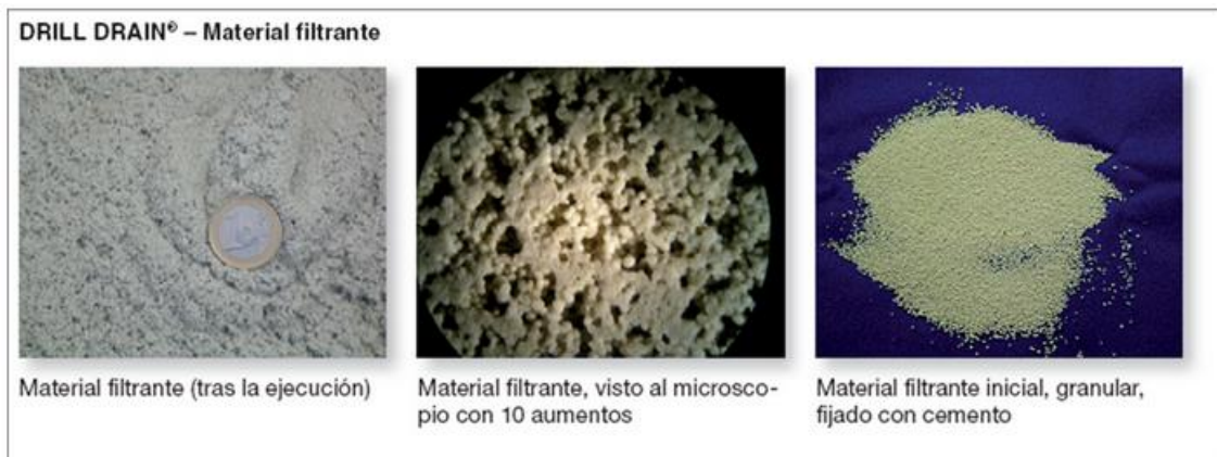
Figura 71: Material Drill Drain. Fuente: Ischebeck Ibérica S.L.
