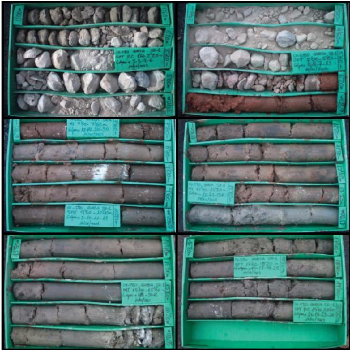
Figura 39: Sondeo rotativo 1. Fuente: Prodein, S.L.
