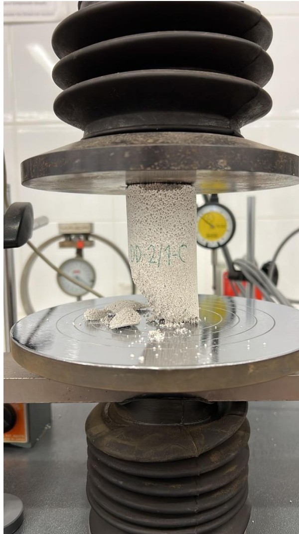
Figura 73: Rotura de la muestra de Drill Drain. Fuente: Laboratorio Geotecnia UPV
