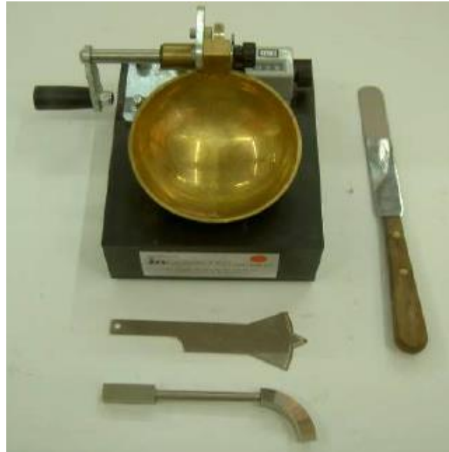
Figura 44: Equipo para determinación del Límite Líquido. Fuente: Asignatura Geotecnia y Cimientos.
