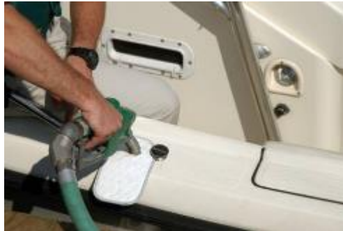
Figura 7: Material absorbente combustible situado en el boquerel. Fuente: https://www.escuelamaritima.es/blog/%C2%A1accidentes-no-recomendaciones-para-repostar-la-embarcaci%C3%B3n
