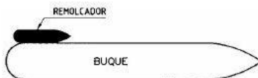
Figura 38. Trabajo abarloado de un remolcador. Fuente: Ingeniero Marino
