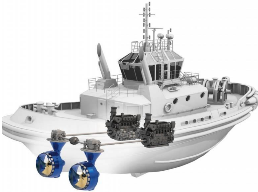
Figura 33. Sistema Schottel (SRP) en embarcación. Fuente: El Universal
