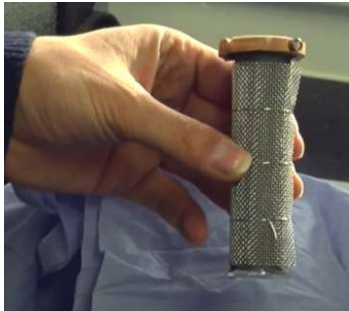
Figura 7. Una celda de combustible microbianas usadas en Pee Power (Urine-tricity Phase III: Electricity from Urine, s. f.).
