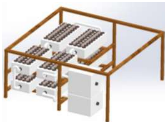
Figura 12. Representación en 3D de la pila de MFC con los tanques uno de entrada y otro de salida justo debajo del urinario (Manuscript_ESWATER.pdf, s. f.) .
