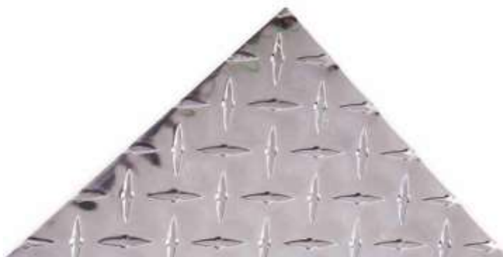
Figura 102. Lamina de aluminio antiderrapante 3003 con relieve de diamante (Lamina antiderrapante de aluminio de metales diaz, s. f.).
