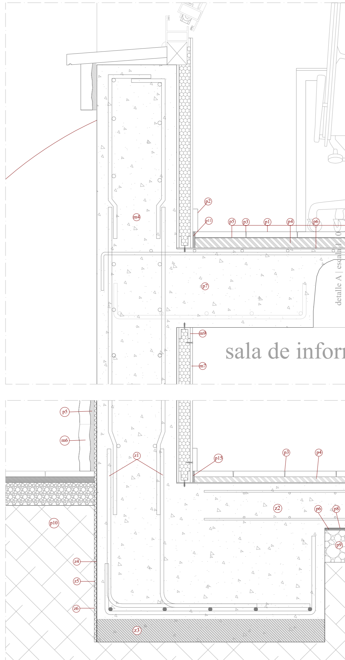
sección constructiva transversal | escala 1:50
