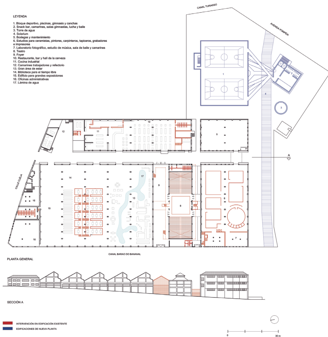
Figura 7. Lina Bo Bardi, Talleres del SESC Pompéia, São Paulo (Brasil), 1977-1986. Planta general del conjunto en la que se muestra las distintas naves de la fábrica existente, identificando las intervenciones realizadas en esta, las edificaciones de nueva planta que acogen el programa deportivo, la torre de agua y los espacios exteriores. Sección transversal del conjunto realizada por la calle interna de la fábrica.
