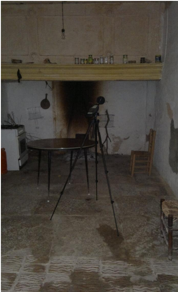
Figura 17: Sonòmetre separat 1 m de les paraments
