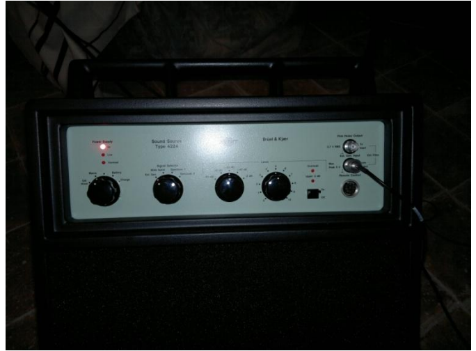
Figura 25: Connexió de cable del sonòmetre a l'altaveu
