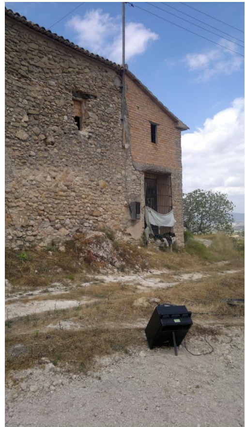
Figura 21: Directivitat de l'altaveu per mesurar l'aïllament de les façanes
