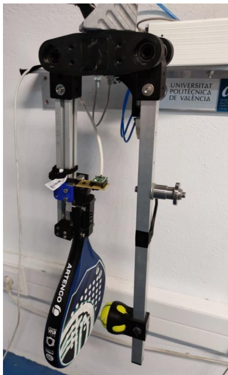
Ilustración 43: Pala colocada en la estación de golpeo
