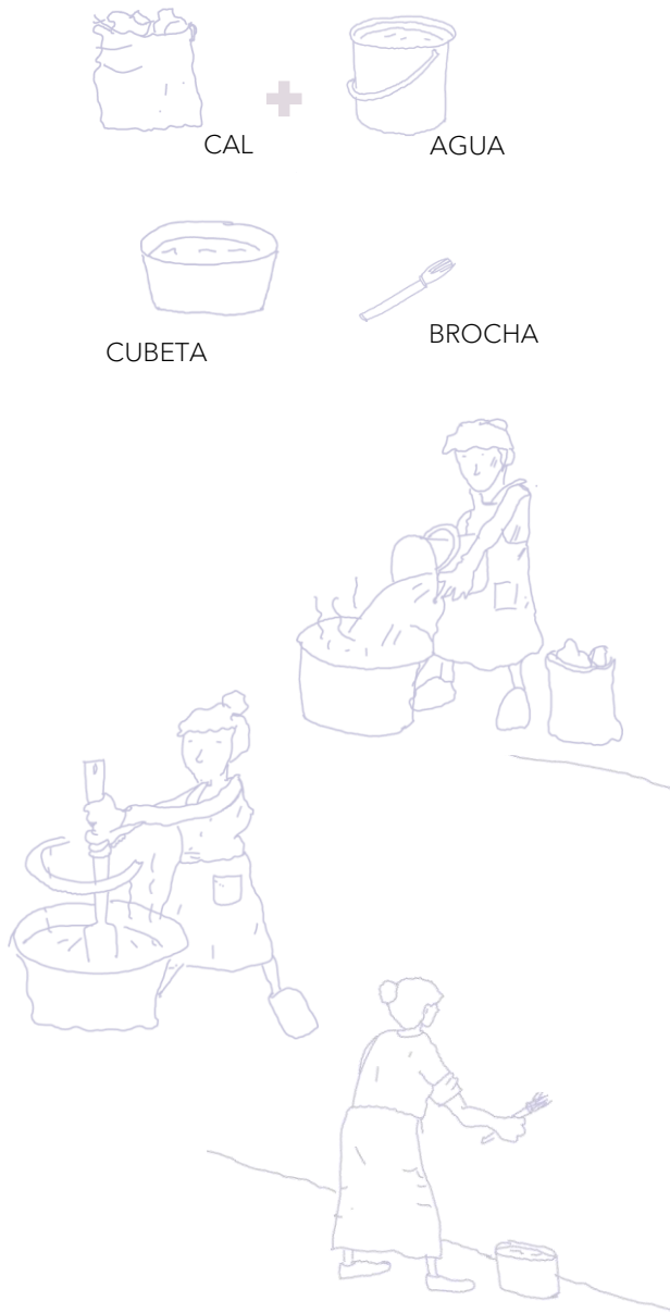
FIGURA 35. Utensilios para el encalado y proceso de aplicación.
