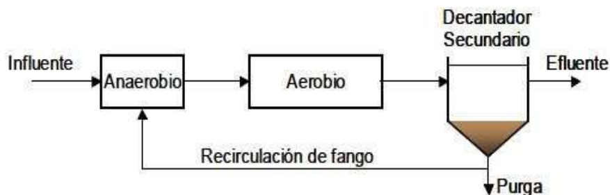
Figura 14. Esquema de Eliminación Biológica de Fósforo A/O (Puga, 2016)
