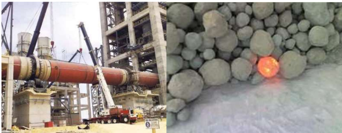
Figura 2.12 Proceso de clinkerización de Cemento Portland. Fuente: (Herrera, 2018)
