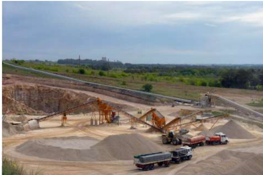
Figura 2.6 Trituración de la materia prima para fabricación de Cemento. Fuente: (Barbudo, 2010)
