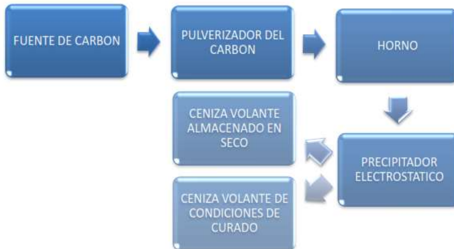
Figura 2.21 Proceso de obtención de la ceniza volante. Fuente: Adaptado de (Corona Zazueta, 1997).
