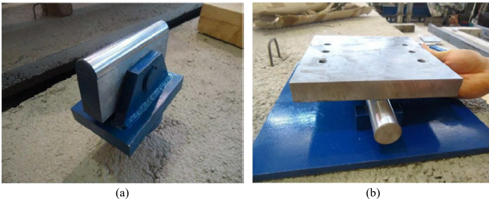
Fig. 4. Aparatos de apoyo y carga (Ciurana, 2014; Rueda-García, 2014): (a) Acople en forma de rótula para el actuador hidráulico; (b) Apoyo deslizante.
