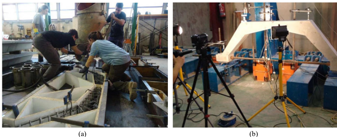
Fig. 6. Fotografías del trabajo en laboratorio (Ciurana, 2014; Rueda-García, 2014): (a) Hormigonado; (b) Ensayo.
