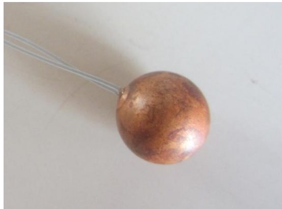
Fig. 21: Esfera de coure utilitzada per al calibratge.
