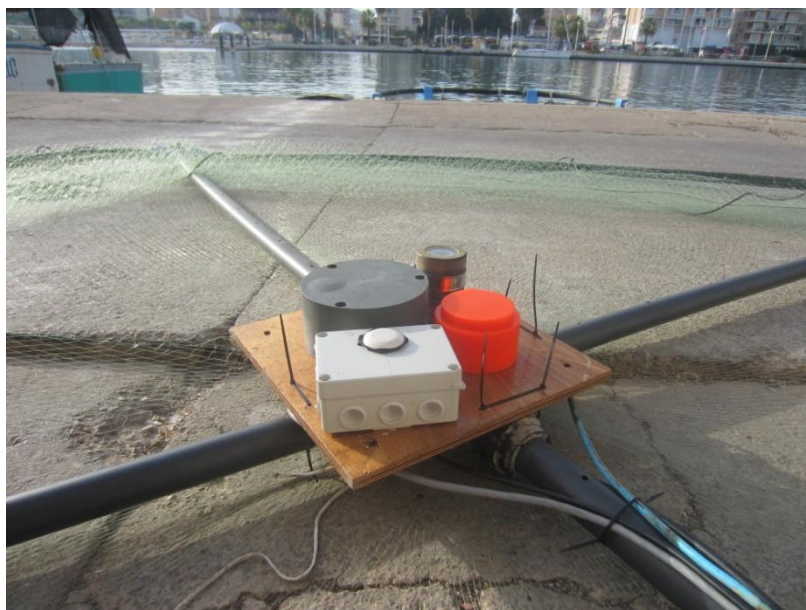
Fig. 14: Imatge de la plataforma amb els transductors i la càmera.
