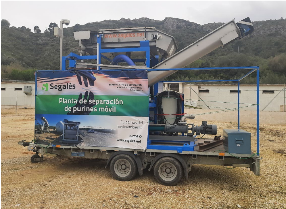
Figura 3. Equipo móvil de separación sólido-líquido de purines
