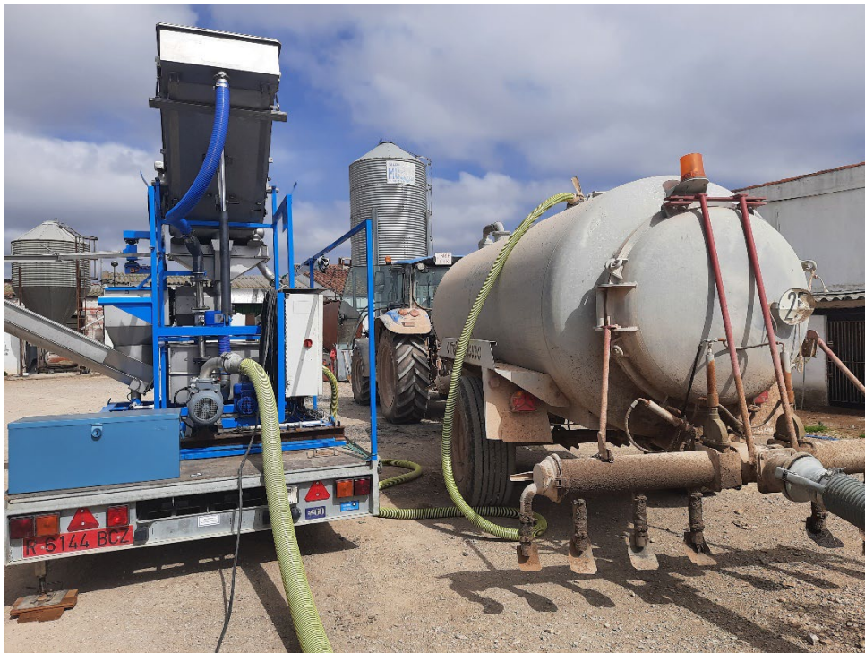
Figura 4. Detalle de la conexión de la cisterna de purines al equipo de separación sólido-líquido
