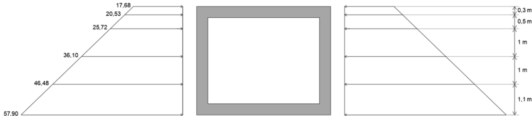
Figura 13. Distribución de empujes en reposo en \text{KN/m}^2 . Situación desfavorable (Fuente: Elaboración propia)
