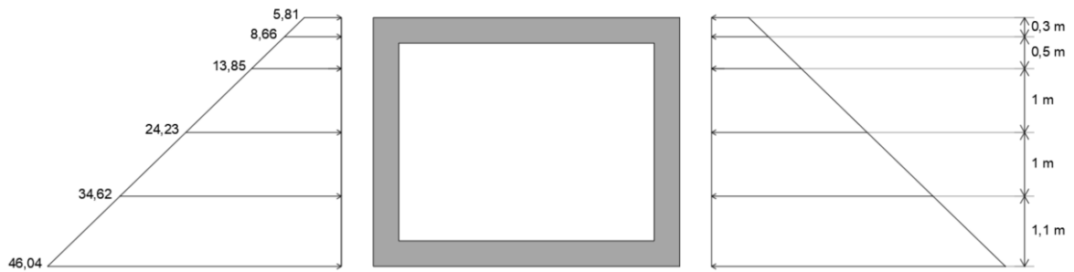
Figura 5. Distribución de empujes en reposo en \text{KN/m}^2 . Situación favorable (Fuente: AutoCAD 2022)
