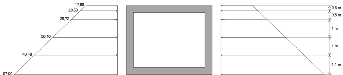
Figura 6. Distribución de empujes en reposo en \text{KN/m}^2 . Situación desfavorable (Fuente: AutoCAD 2022)
