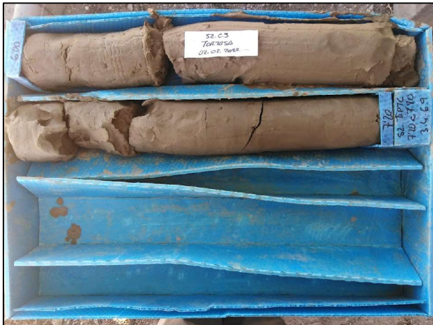
CAIXA N°3. DE 6,00 A 7,20 m. FI DE SONDEIG
