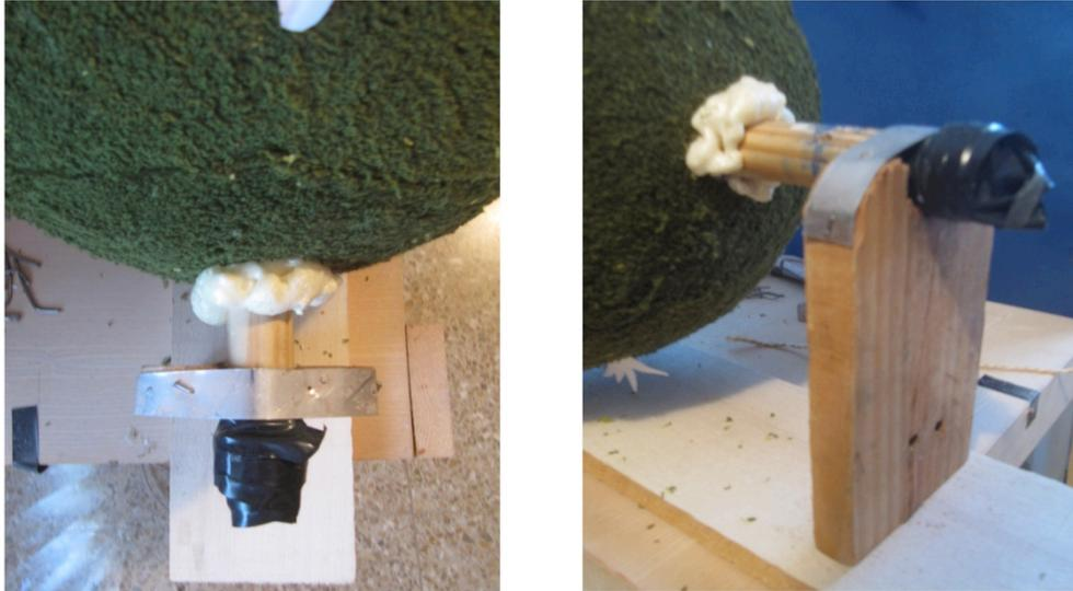
**34. Soporte para el eje de rotación de la bola.**
