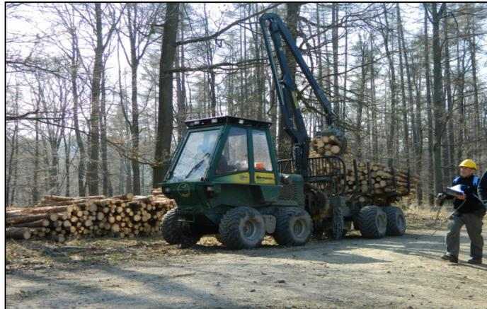
**Figura 17.** Cosecha de trozas delgadas de coníferas para uso energético mediante procesadora y tractor autocargador
