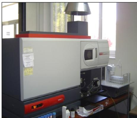
**Figura 43.** Espectrofotómetro de emisión atómica ICP para determinar los minerales y S
