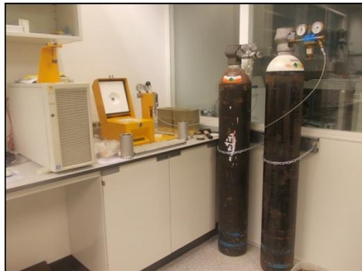
**Figura 45.** Calorímetro marca Cal2k modelo ECO, laboratorio del IIE-UPV.
