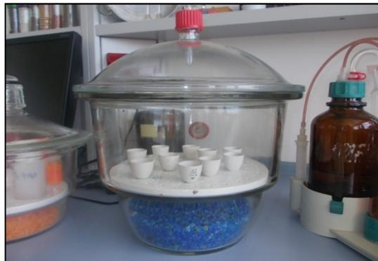
**Figura 40.** Desecador con muestras para su secado
