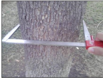
**Figura 34.** Determinación de diámetros con forcípula en fuste
