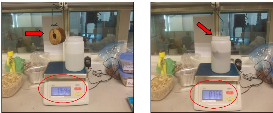
**Figura 37.** Determinación de la densidad de la madera por el teorema de Arquímedes, según Olesen (1971)
