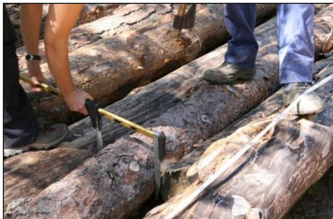
**Figura 22.** Medición de diámetros del fuste a diferentes alturas
