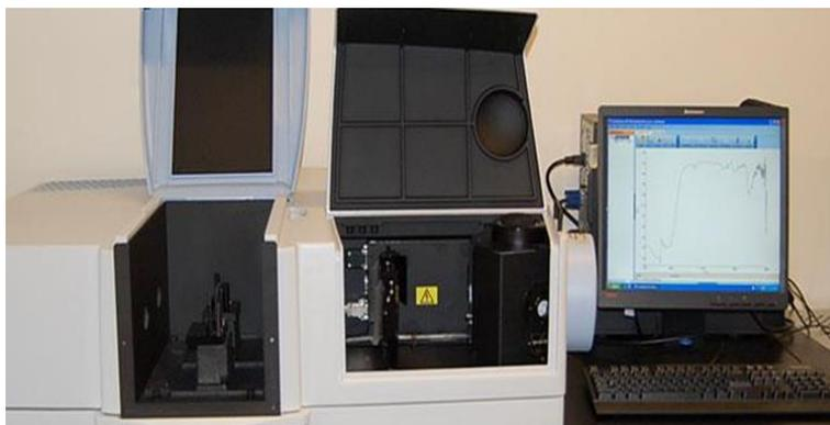
Figure 2-11 : Spectrophotomètre Perkin Elmer Lambda 750
