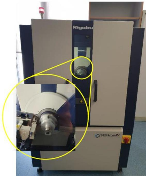
**Figure 2-13 : Photo de l'appareil de diffraction des rayons X utilisé**
