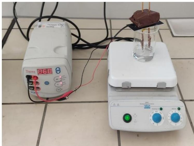
**Figure 2-3 : Dispositif d'anodisation électrochimique utilisé**
