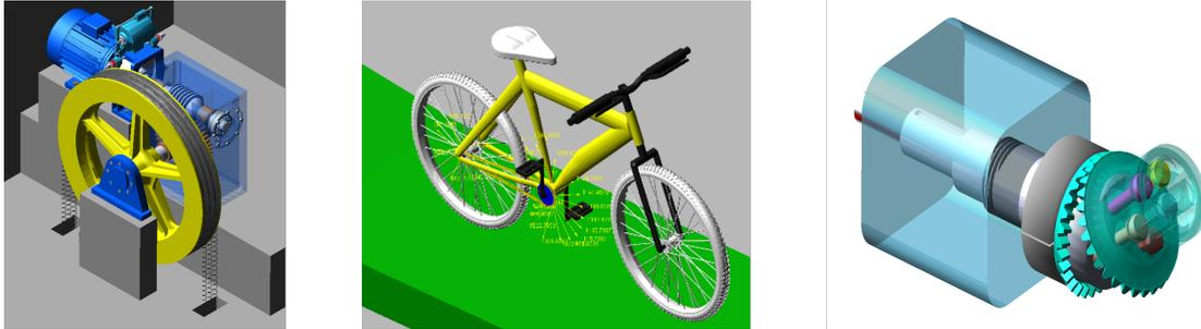
Figura 1: Modelo de un grupo reductor de un ascensor, de transmisión de cadena en bicicleta y de bomba hidráulica de pistones con motor eléctrico.
