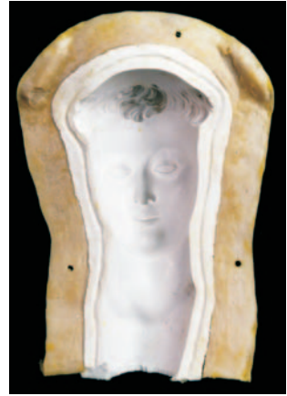
Motle de silicona amb caixa de fibra de vidre i resina de polièster.
