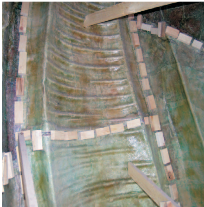
Interior d'una peça realitzada amb estratificació de plàstic reforçat, amb fibra de vidre i resina de polièster.
