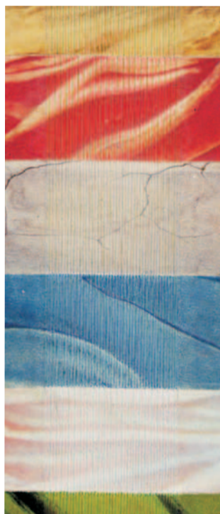
Exercicis de reintegració cromàtica per mitjà de la tècnica del tratteggio sobre una llacuna simulada.
