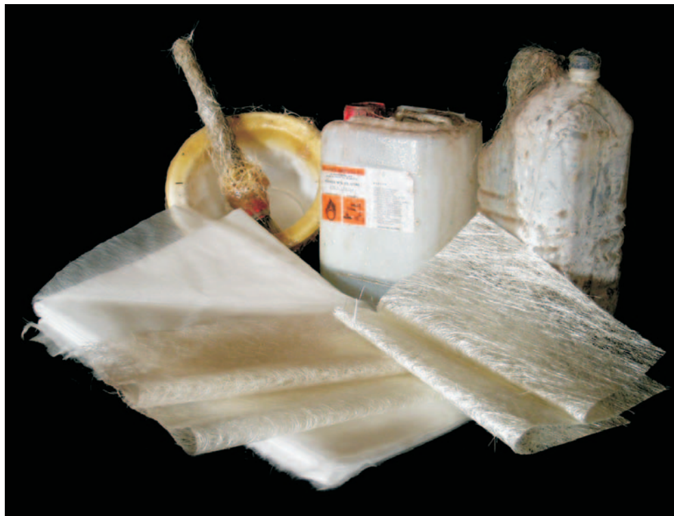
Resina de polièster i fibra de vidre (mat) de diversos gruixos.
