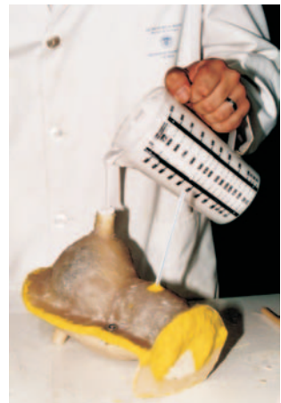
Inserció de la silicona entre la caixa i el model, gràcies al buit sorgit després de l'eliminació de la plastilina.
