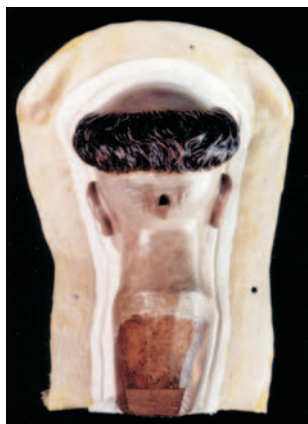
Motle de silicona amb caixa de fibra de vidre i resina de polièster. Model original disposat per a rebre una segona matriu d'elastòmer.
