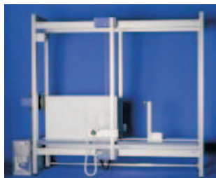
Termotalladora amb control numèric, el traçat de la qual s'estableix per ordinador.
