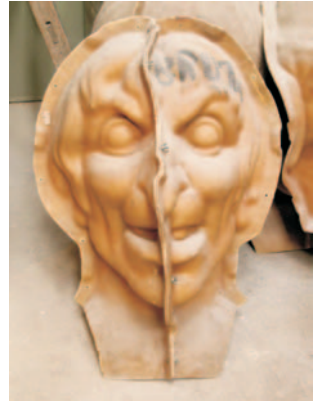
Motles de fibra de vidre i resina de polièster d'estructura senzilla, a dues i quatre parts.
