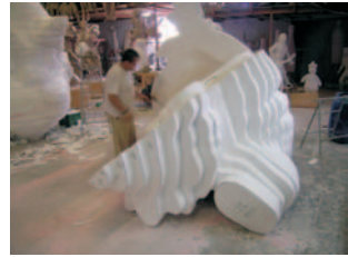
Adhesió de les plaques de poliexpan amb espuma de poliuretà.
