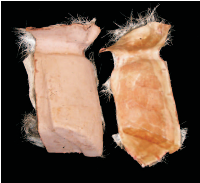
Reproducció mixta, amb un estrat de fibra de vidre i resina de polièster sobre una capa de cartó fi.
