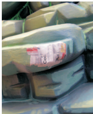
Deteriorament en una peça de polièspan, solucionat amb l'aplicació de paper de periòdic encolat amb acetat de polivinil.
