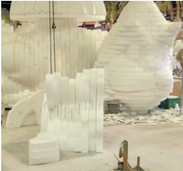
Muntatge per superposició dels perfils projectats sobre el poliexpan.
