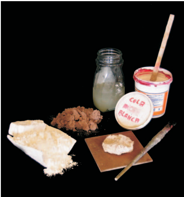
Materials fonamentals per a l'elaboració de la massilla tradicional: panet, engrut, cola blanca i raspadura de cartó.
