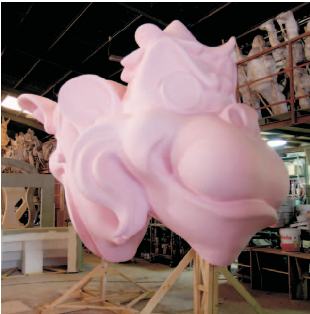
Emprimació d'un remat amb diverses mans de pasta comercial lleugerament tenyida.
