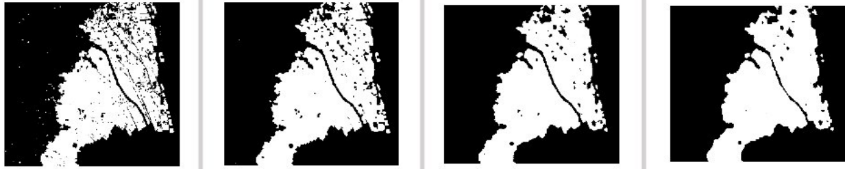
Figura 26: Mascara resultante del proceso sin filtrar, resultado con filtro 3x3, resultado con filtro 5x5 y resultado con filtro 7x7, respectivamente
