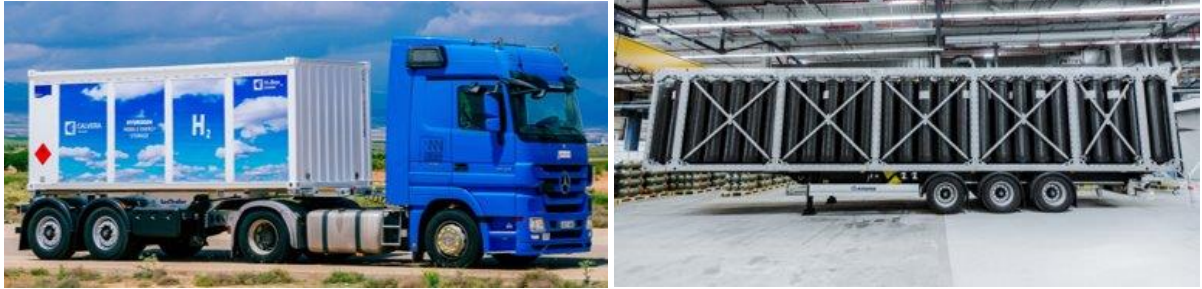
Figura 49 Modelo de Calvera 400kg y Modelo de Hexagon 1130kg [Hexagon, s.f.] [Calvera, s.f.]
