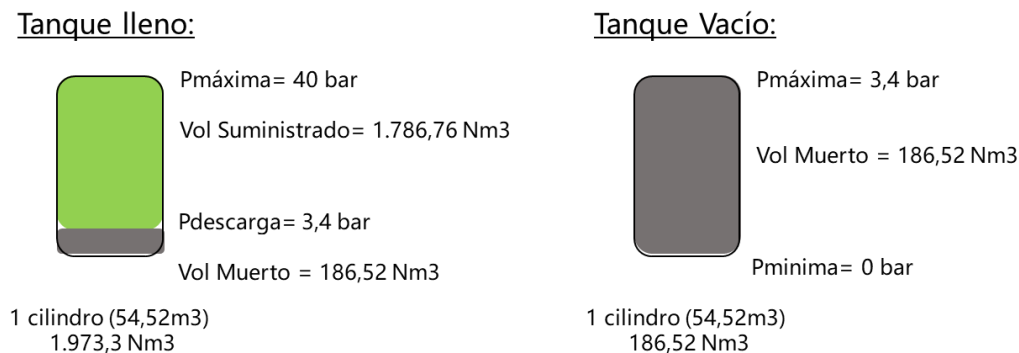
Figura 24 Diagrama tanque de almacenamiento masivo lleno y vacío
