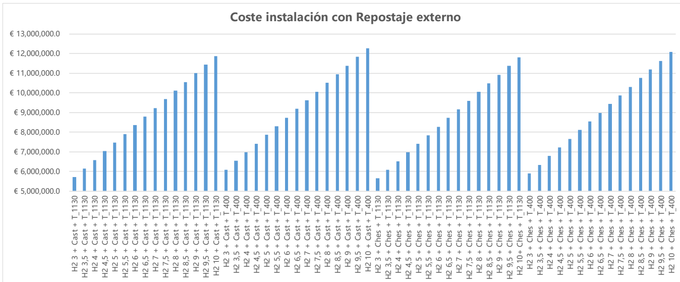
Figura 51 Coste de la HRS al final de su vida útil con compra y transporte de H2 para el Caso #4
