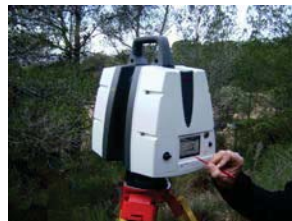
Figura 11: manejo del escáner LiDAR en el monte.
