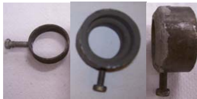
Figura 3.13. Piezas Moldes Fabricada para Probetas Totales.
