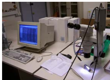
Figura 3.26. Lupa Estereográfica con Cámara de Incorporada.
