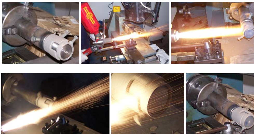
Figura 3.45. Etapas de Proyección Térmica por Llama para una Probeta de Cizalladura.
