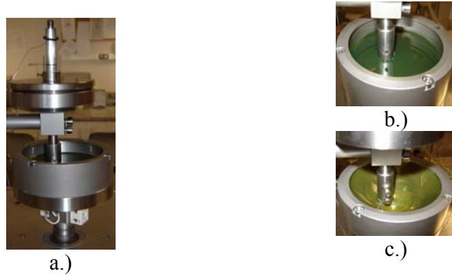
Figura 3.53. Tribómetro a.) Sistema Pin on Disk: b.) Estático Lubricante en Reposo 0 RPM y c.) Dinámico Lubricante en Movimiento 150 RPM.
