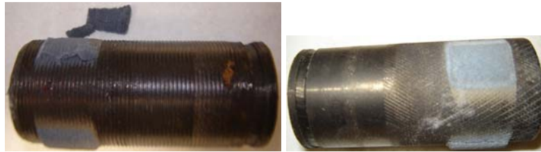
Figuras 4.67. Detalles de Rupturas de Probetas Proyectadas.
