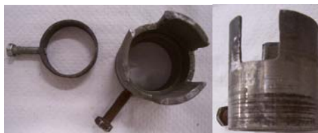
Figura 3.14. Piezas Moldes Fabricada para Probetas Parciales a 3 Trozos
