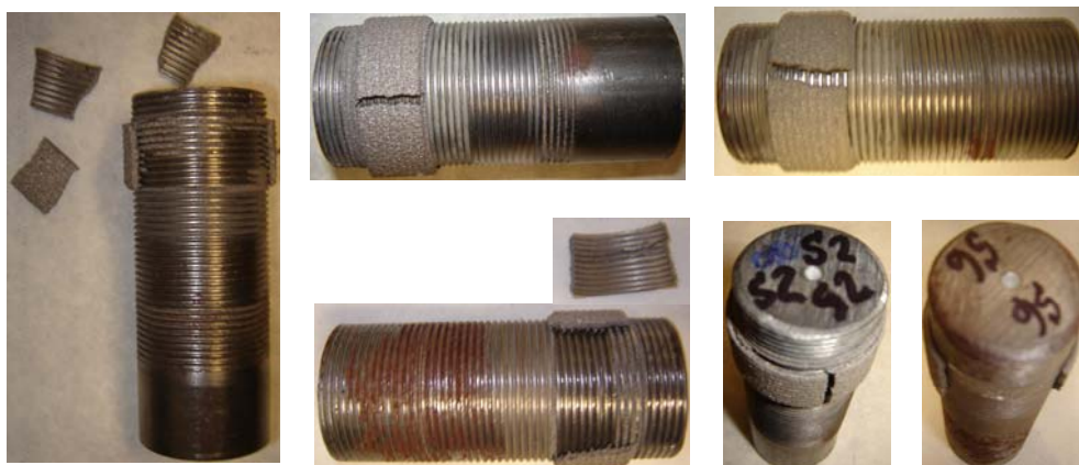
Figuras 4.3. Detalles de Rupturas de Probetas Proyectadas.
