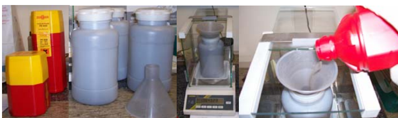
Figura 3.8. Preparación de la aleación de 30%WC+70%Ni.
