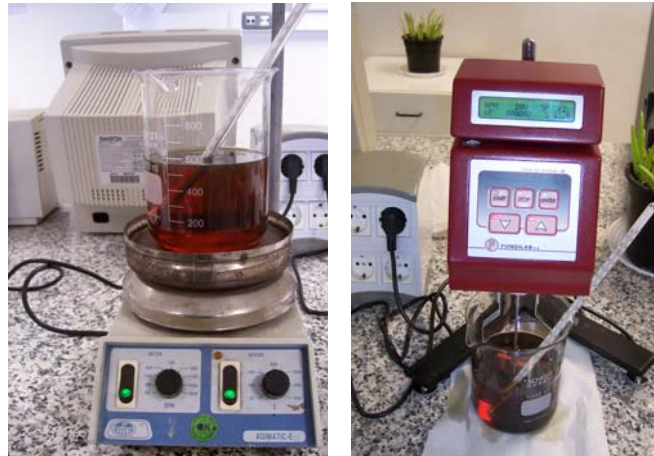
Figura 3.57. Procedimiento en la Medición de la Viscosidad del Aceite CUT – MAX 110: a.) Calentamiento del aceite b.) Determinación de la Viscosidad de aceite.
