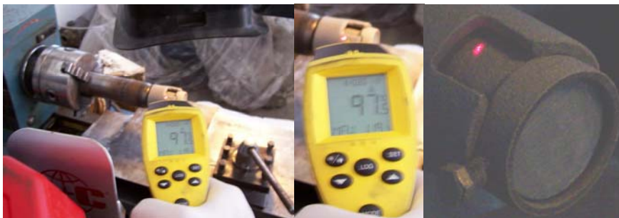
Figura 3.40. Detalles de la Medición de la Temperatura en la Probeta (Sustrato).
