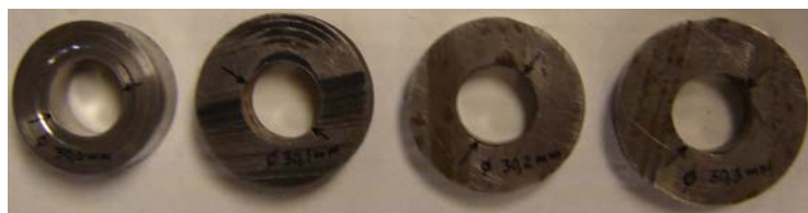
Figura 3.33. Matrices de Corte de diámetros a.) 30,0 mm b.) 30,1 mm; c.) 30,2 y d.) 30,3.
