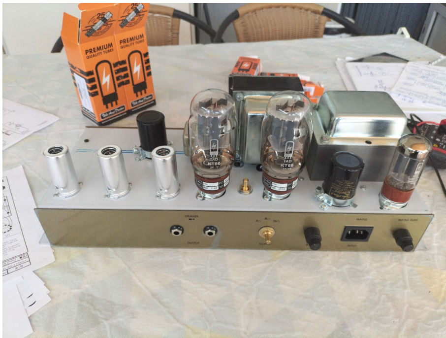
Figura IV.21. Amplificador con válvulas (detrás)
