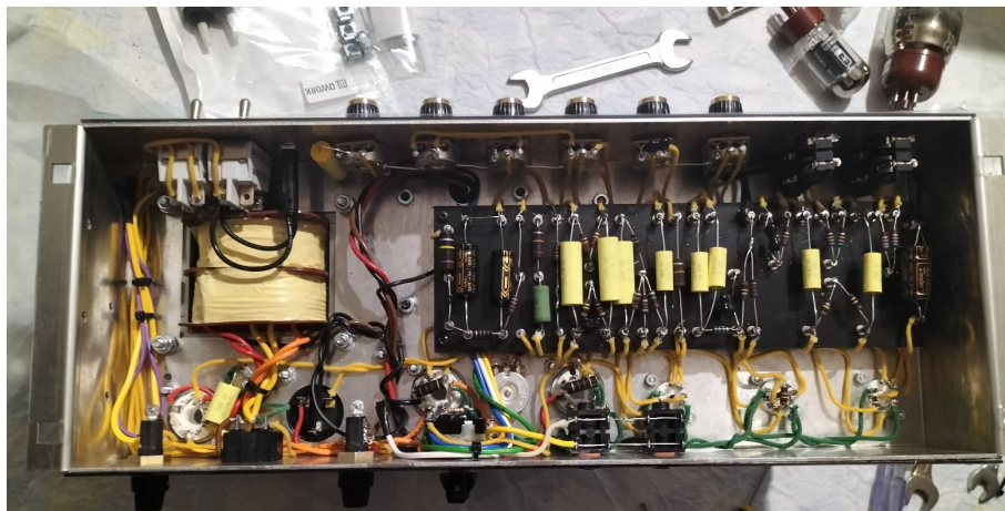
Figura IV.25. Interior completo (con resistencias de 1\Omega )
