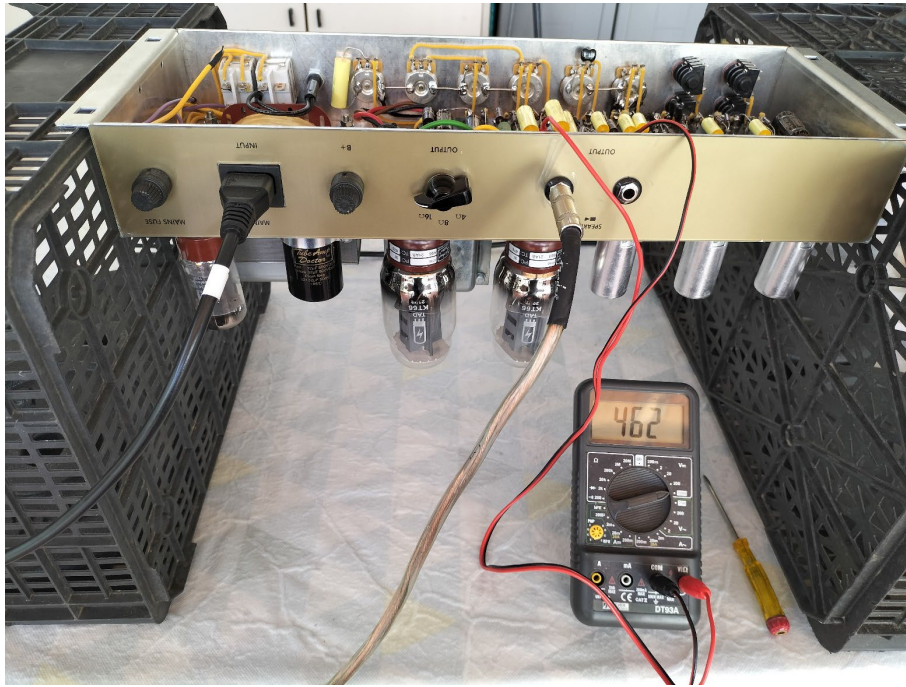
Figura IV.22. Medida de la tensión en vacío
