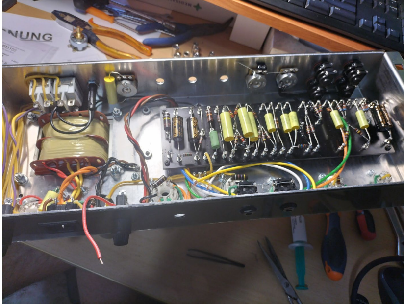
Figura IV.15. Insertando la placa de torretas (sin cablear)
