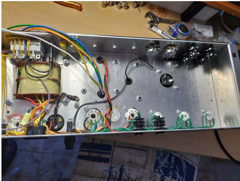
Figura IV.14. Colocando los cables de señal de las válvulas
