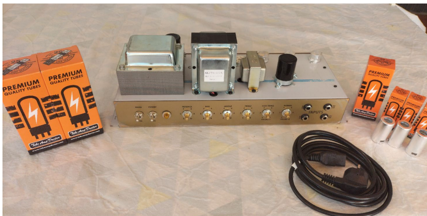
Figura IV.19. Amplificador antes de colocar las válvulas
