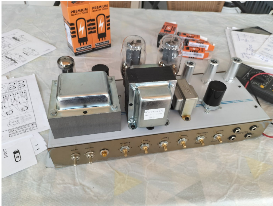
Figura IV.20. Amplificador con válvulas (delante)
