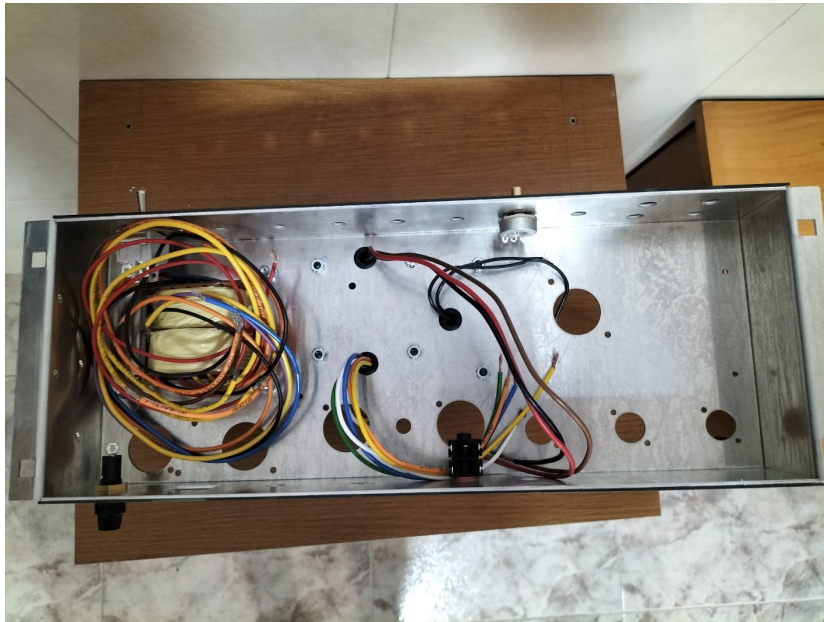
Figura IV.7. Chasis con transformadores y choke (interior)
