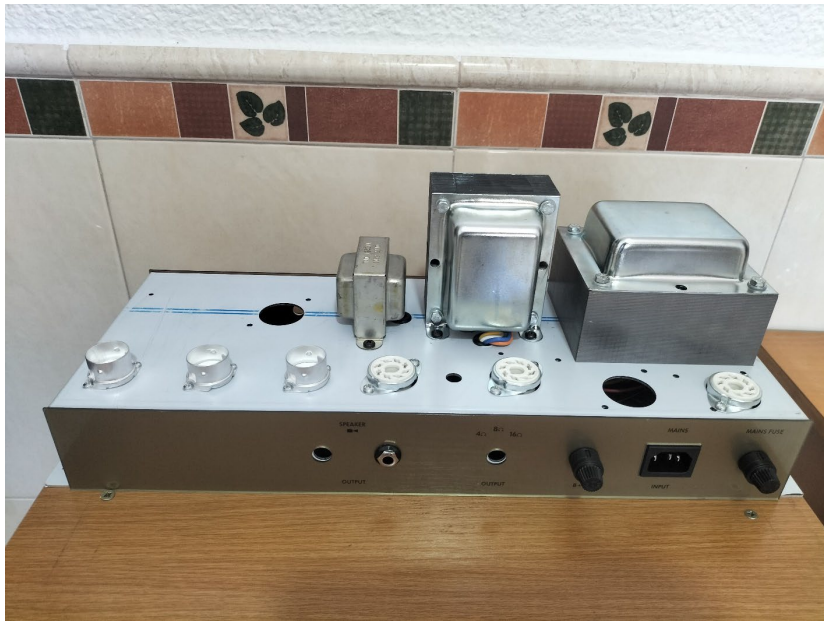
Figura IV.8. Zócalos de válvulas
