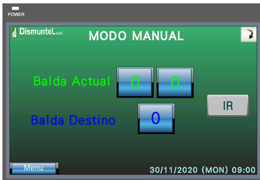
Figura 25. Pàgina mode manual de la pantalla de control del magatzem intel·ligent de Dismuntel
