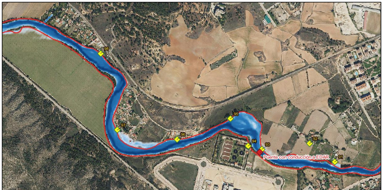
Figura 20. Comparación del DPH del SNCZI y el caudal de 150 m 3 /s simulado.
