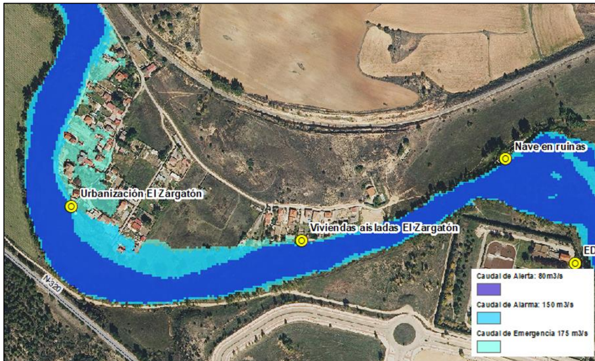
Figura 23. Detalle de la afección nº97 “Urbanización El Zargatón” para el caudal de emergencia.
