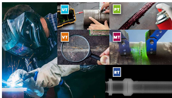
Ilustración 37: ejemplo de algunos ensayos de control de la soldadura
