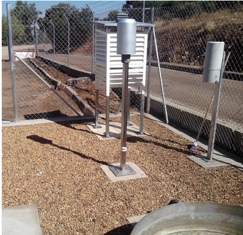
Figura 26. Detalle Estación Meteorológica Presa de Gasset. Pluviómetros y Evaporímetros de lectura automática conectados al SAIH de la Confederación Hidrográfica del Guadiana.
