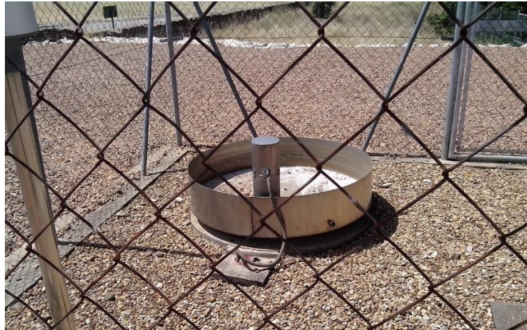
Figura 25. Tanque evaporímetro clase A con lecturas automatizadas enviadas al SAIH de la Confederación Hidrográfica del Guadiana. Presa de Peñarroya.
