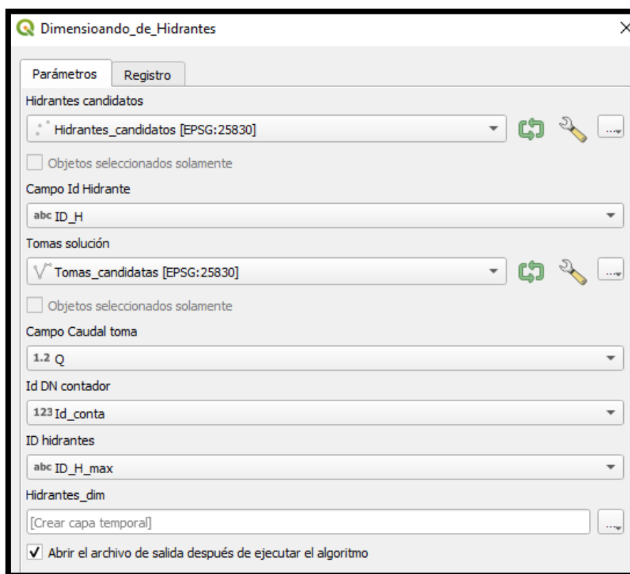
Figura 40: Introducción de datos sobre QGIS 3.X para cálculo del DNB de los hidrantes multiusuario.
