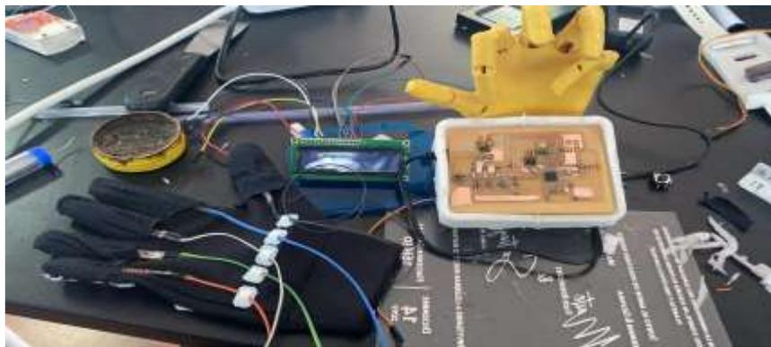
Imagen 79: Montaje de componentes y pruebas del sistema ARTH-aid ExoGlove System.
