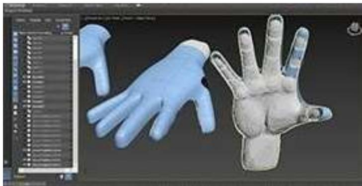
Imagen 55: Diseño de falanges a partir de referencias antropométricas de las medidas en usuarios con artritis
