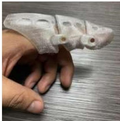
Imagen 57: Primer prototipo de la articulación protésica de las falanges del dedo índice.
