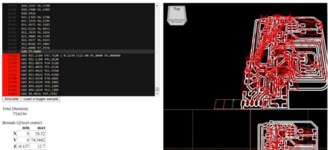
Imagen 72: Simulación de mecanizado para PCB (Tarjeta de circuito impreso).
