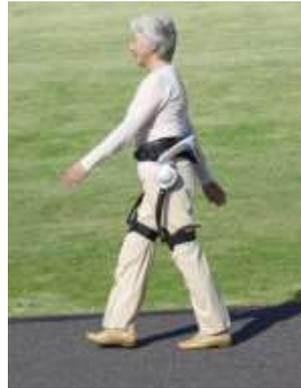
Imagen 31: Exoesqueleto Walking Assist Device fabricado por Honda.
