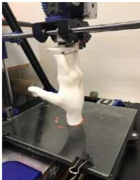
Imagen 53:Proceso de impresión 3D de un modelo de mano con artritis.
