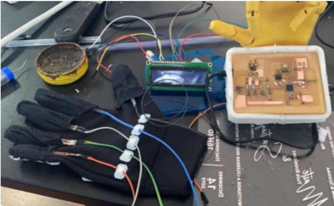
Imagen 66: Cableado, circuito impreso y pantalla de ARTH-aid System
