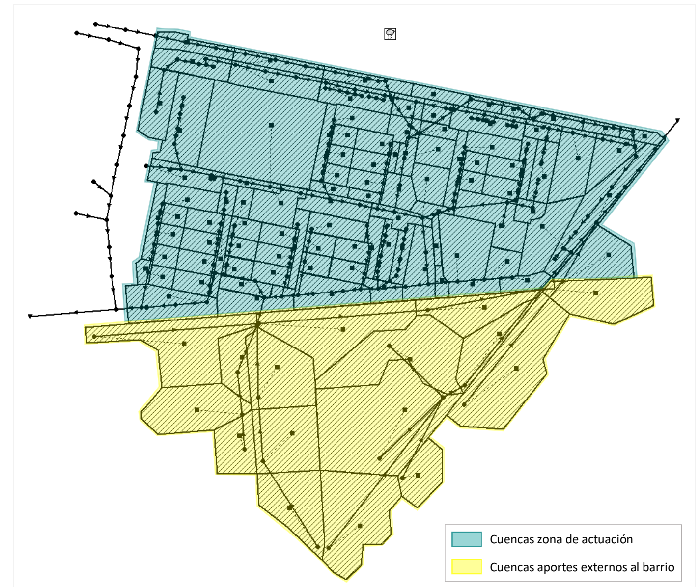
Figura 11. Modelo de simulación para el estudio hidráulico de la red existente. Fuente: Elaboración propia en SWMM.
