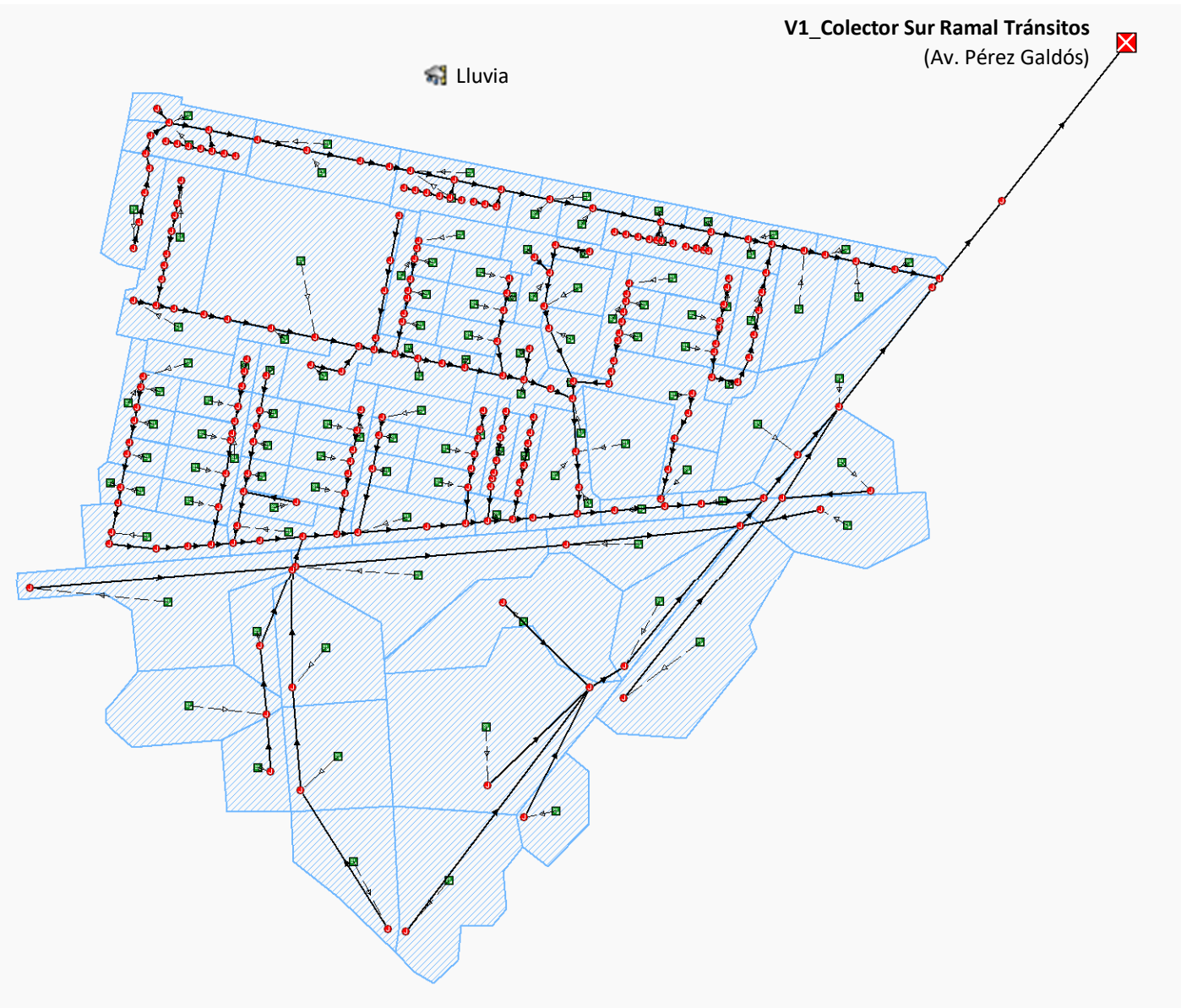
Figura 24. Planta del modelo de simulación de la red proyectada. Fuente: Elaboración propia en Autodesk Storm and Sanitary Analysis (SSA).
