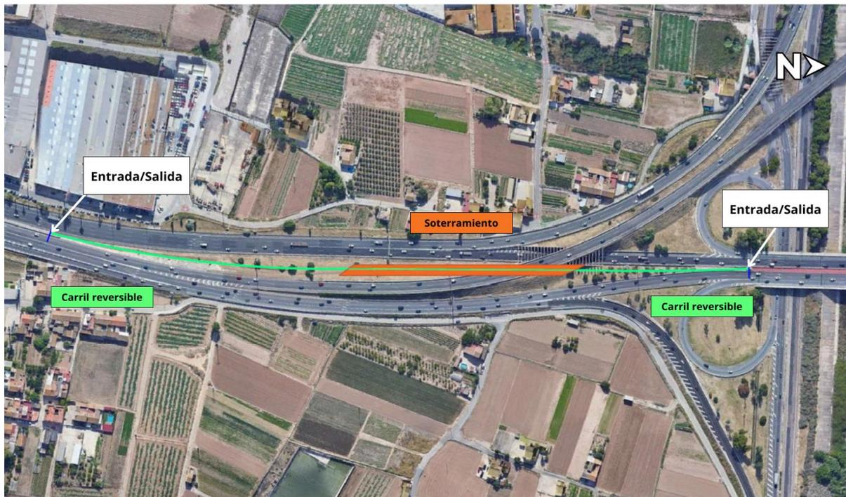
Figura 18. Disposición del carril reversible en el tramo 2. Fuente: Google Earth
