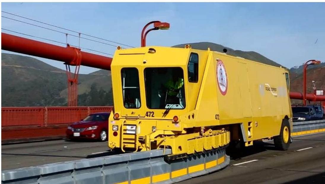
*Figura 29. Road Zipper Barrier en el Golden Gate. Fuente: CNBC*
