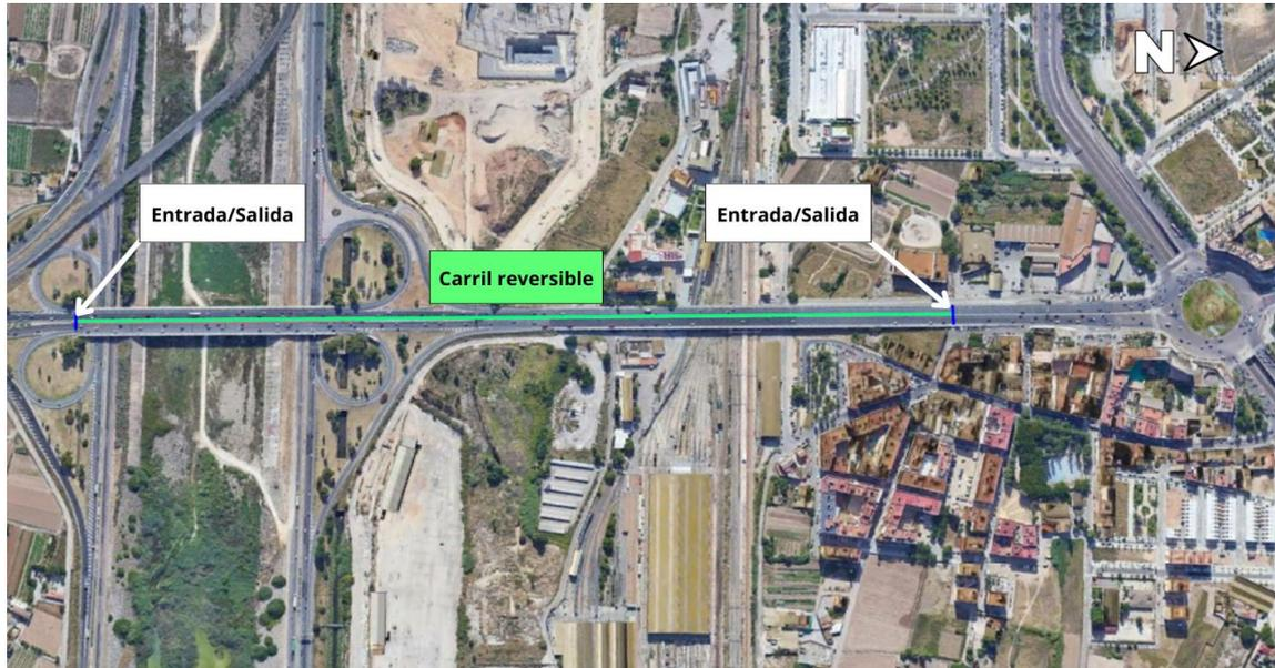
Figura 17. Disposición del carril reversible en el tramo 1. Fuente: Google Earth
