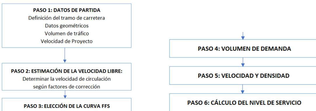
Figura 23. Criterios de cálculo del Nivel de Servicio según el HCM. Fuente: Propia
