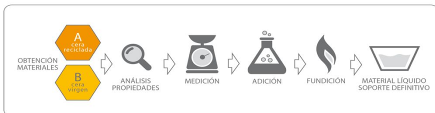
Figura 3. Proceso técnico para obtener el soporte definitivo de la obra/muestra. Fuente: elaboración propia en colaboración con José Manuel Ruiz Martín.
