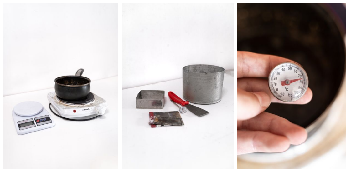
276. De izquierda a derecha: báscula digital, placa eléctrica portátil, cazo mediano, molde metálico cuadrado 10x10cm, espátulas, termómetro y filtro de aluminio.
