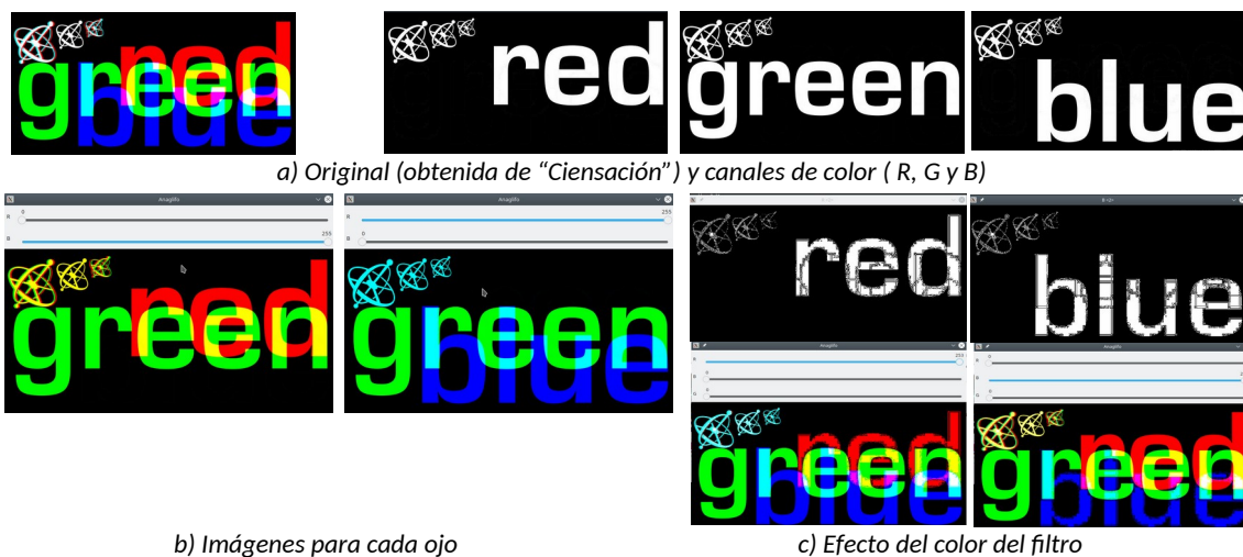
Figura 6: Salida de la ejecución de opencv_anaglif : (a) original, (b) las imágenes tras simular el efecto de los filtros y (c) cómo influye la elección el color para simular el filtro.
