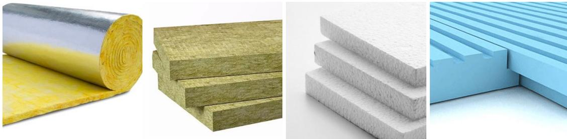
Figuras 12: Tipos de aislamiento térmico. (fibra de vidrio, lana mineral, EPS y XPS)
