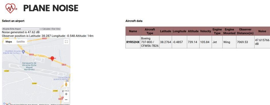
Figura 10.2: Salida cálculo del ruido para un instante concreto
