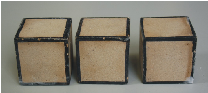
Figura 11.29. Probetas de morteros elaborados con conglomerante acrílico (MA) sometidas al ensayo de cristalización salina. Las probetas se muestran estables al desgaste, aunque presentan un velo blanquecino formado al precipitar agregados salinos en superficie.
