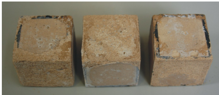
Figura 11.26. Probetas de mortero cal-yeso (MN) Tosca de Rocafort al finalizar los ciclos de cristalización salina. Se perciben desagregación granular y desmoronamiento.
