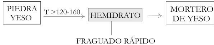
Figura 3.7. Composición y tecnología de fabricación del mortero de acabado en Época Egipcia.
