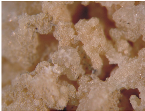
Figura 6.3. Tosca de Rocafort. Lupa binocular 80x. Fuerte porosidad. Cristalinidad de calcita.
