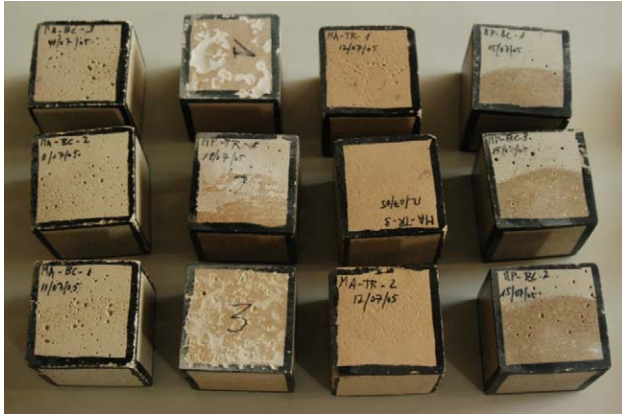
Figura 11.23. Probetas de morteros de matriz sintética sometidas al ensayo de resistencia a la heladicidad al finalizar los ciclos. Las probetas mantienen su forma cúbica.
