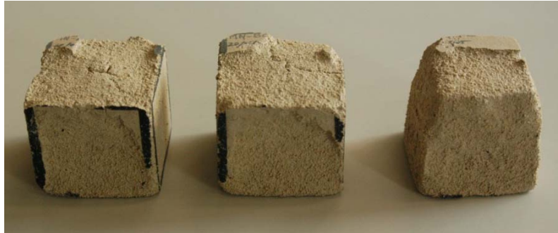
Figura 11.20. Probetas de mortero cal-yeso (MN) Bateig Crema durante los ciclos de helacidad (ciclo n° 35). Se observa la presencia de grietas, desagregación granular, desaglomeración, etc.
