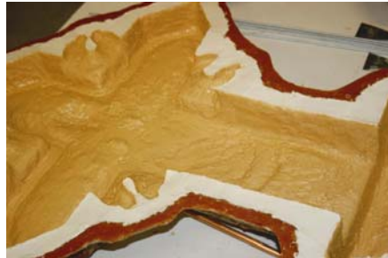
Figura 12.12. Aplicación del mortero mediante sistema de estratificación operando con el molde abierto en posición horizontal.
