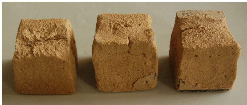
Figura 11.22. Probetas de mortero cal-yeso (MN) Tosca de Rocafort durante los ciclos de helacidad (ciclo n° 39/49). Se perciben grietas, pérdida de volumen desagregación granular, desmoronamiento y desplazación.
