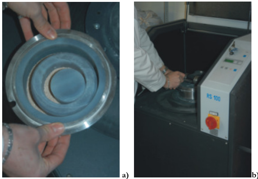
Figura 10.3.(a-b). a) Juego de discos de molienda de ágata. b) Detalle del proceso de manipulación y puesta en marcha.
