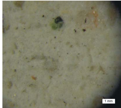
Figura 11.66. Imagen obtenida con microscopio óptico (80X) de la superficie del mortero cal-yeso Bateig Crema tras tres meses de exposición. Presencia de microorganismos (1ª extracción).
