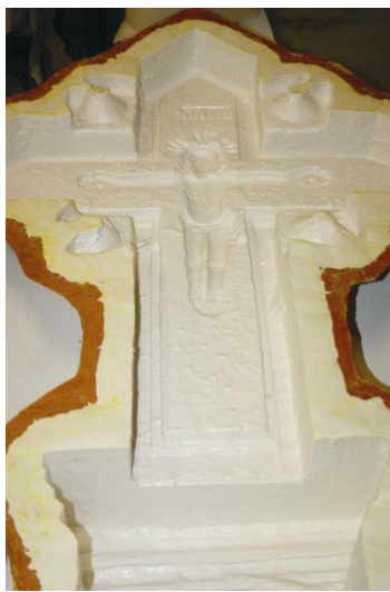
Figura 8.15.(a-f). Fases de realización de un molde elástico por el procedimiento de estratificado.
