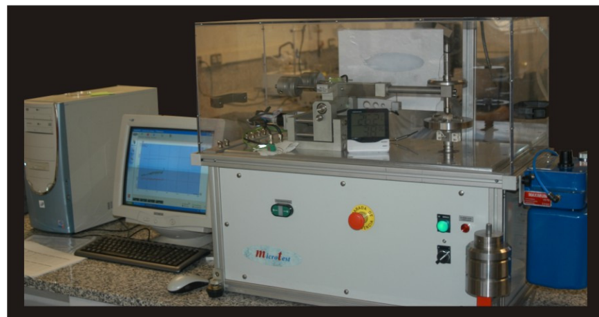
Figura 11.14. Tribómetro con sistema pin-on-disk. Máquina de desgaste por rozamiento.
