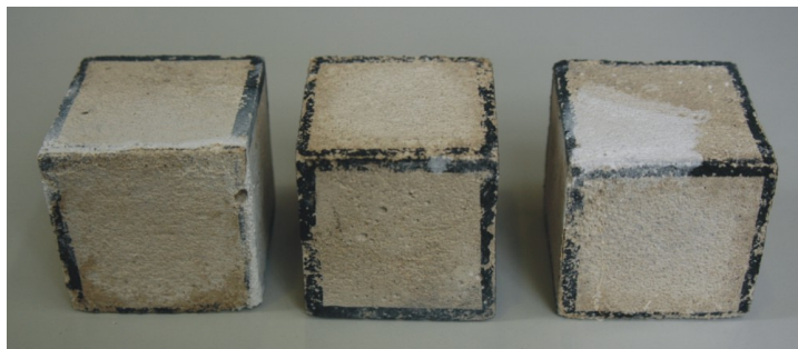
Figura 11.27. Probetas de mortero cal-yeso (MN) Bateig Crema más el aditivo Ácido Bórico al finalizar el ensayo de cristalización salina. Se observa desagregación granular y desmoronamiento, así como eflorescencias salinas en superficie.
