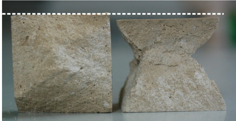
Figura 11.11. Mortero acrílico Bateig Crema tras el ensayo de compresión. Existe compresión sin desmoronamiento de partículas.
