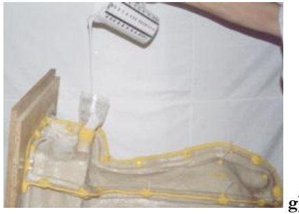
Figura 8.13.(a-h). Fases de realización de un molde elástico por el procedimiento de colada.
