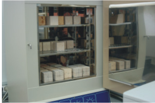
Figura 11.24. Detalle de las probetas en fase de inmersión con la disolución salina saturada y, fase de secado de las probetas en la estufa.
