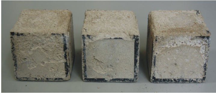
Figura 11.28. Probetas de mortero cal-yeso (MN) Bateig Crema más el aditivo Mowilith SDM 5 al finalizar los ciclos de sales. Se observa desagregación granular, descamación y desplazación, así como eflorescencias salinas en superficie.
