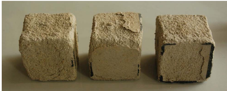
Figura 11.21. Probetas de mortero cal-yeso (MN) Bateig Crema más el aditivo Mowilith SD 5 al finalizar los ciclos de hielo-deshielo. Se observa desagregación granular, descamación y desplazación.
