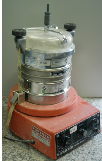
Figura 10.4. Torre de tamices durante el proceso de tamizado de los áridos.
