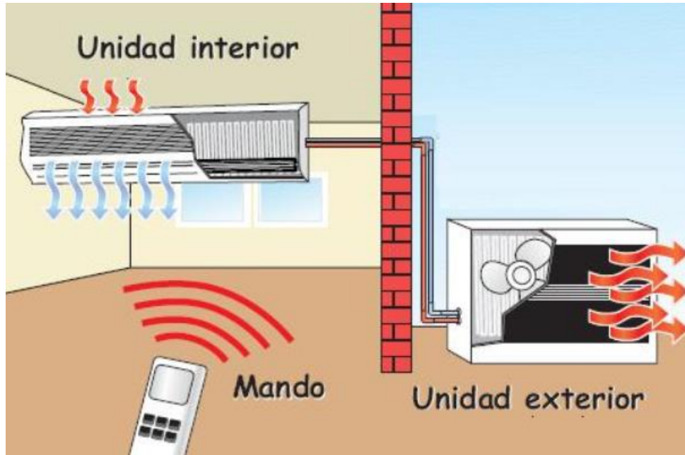
Ilustración 2. Disposición de un sistema Split.
