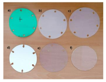
Figure 4. Radon barrier samples: a) Sisalex, b) LDPE, c) PP, d) PS, e) PVC, f) PMMA
